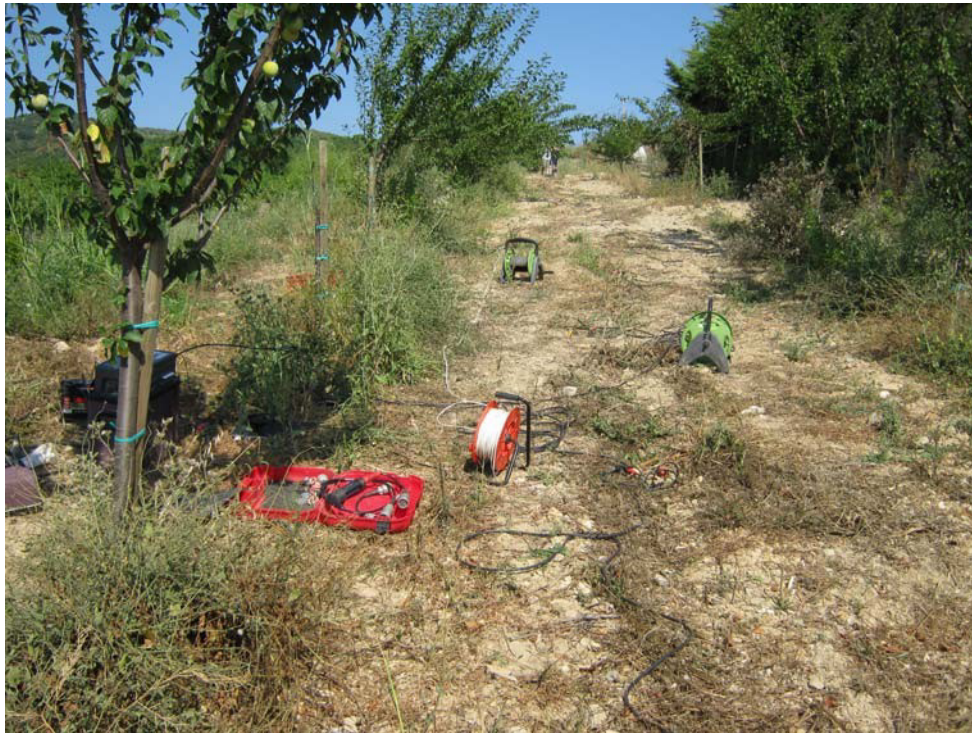
Profilo ST1 – Panoramica del sito di indagine e stralcio dello stendimento di geofoni 10 Hz con interdistanza 3m.
