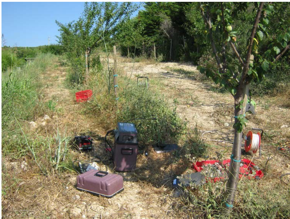
Profilo ST1 – Stralcio dello stendimento di geofoni e strumentazione utilizzata per l'acquisizione del segnale sismico (sismografo Geometrics Strataviser NZXP 48 canali).
